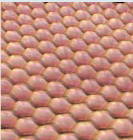
Dreidimensionale Abbildungen von Oberflächenatomen eines Kupferkristalls in unterschiedlichen Auflösungen.
