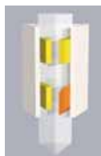
Für die Grobannäherung "kriecht" der Saphirstab, von den Piezobeinchen getragen, Schritt für Schritt nach oben bzw. unten. Je nach Konstruktion des Mikroskops ist am Ende des Saphirstabes die Probe oder die Sonde befestigt.
