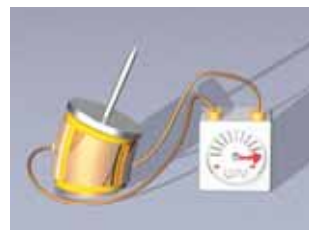
Durch geschickt eingestellte Spannungsdifferenzen zwischen den vier Außenelektroden und der Innenelektrode lässt sich der Röhrenscanner in alle Raumrichtungen auf Bruchteile eines Atomdurchmessers genau positionieren (siehe Text).
