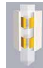
Für die Grobannäherung "kriecht" der Saphirstab, von den Piezobeinchen getragen, Schritt für Schritt nach oben bzw. unten. Je nach Konstruktion des Mikroskops ist am Ende des Saphirstabes die Probe oder die Sonde befestigt.
