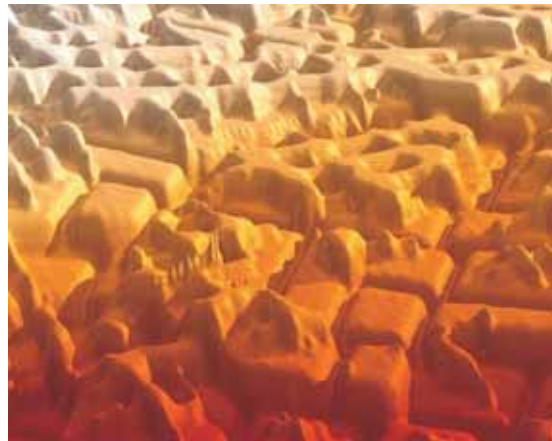
"Nanolandschaft" auf einer mit Stickstoff behandelten Kupferoberfläche
