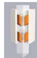
Für die Grobannäherung "kriecht" der Saphirstab, von den Piezobeinchen getragen, Schritt für Schritt nach oben bzw. unten. Je nach Konstruktion des Mikroskops ist am Ende des Saphirstabes die Probe oder die Sonde befestigt.
