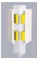
Für die Grobannäherung "kriecht" der Saphirstab, von den Piezobeinchen getragen, Schritt für Schritt nach oben bzw. unten. Je nach Konstruktion des Mikroskops ist am Ende des Saphirstabes die Probe oder die Sonde befestigt.
