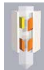
Für die Grobannäherung "kriecht" der Saphirstab, von den Piezobeinchen getragen, Schritt für Schritt nach oben bzw. unten. Je nach Konstruktion des Mikroskops ist am Ende des Saphirstabes die Probe oder die Sonde befestigt.
