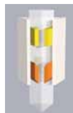
Für die Grobannäherung "kriecht" der Saphirstab, von den Piezobeinchen getragen, Schritt für Schritt nach oben bzw. unten. Je nach Konstruktion des Mikroskops ist am Ende des Saphirstabes die Probe oder die Sonde befestigt.
