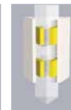
Für die Grobannäherung "kriecht" der Saphirstab, von den Piezobeinchen getragen, Schritt für Schritt nach oben bzw. unten. Je nach Konstruktion des Mikroskops ist am Ende des Saphirstabes die Probe oder die Sonde befestigt.
