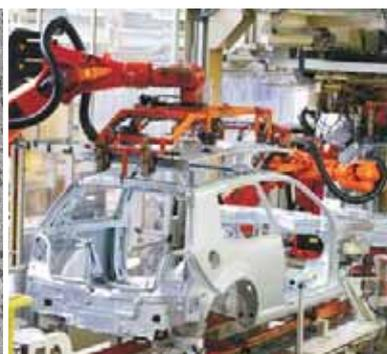
Abb. 2: Montageband einer Rohkarosse (© Volkswagen AG).
