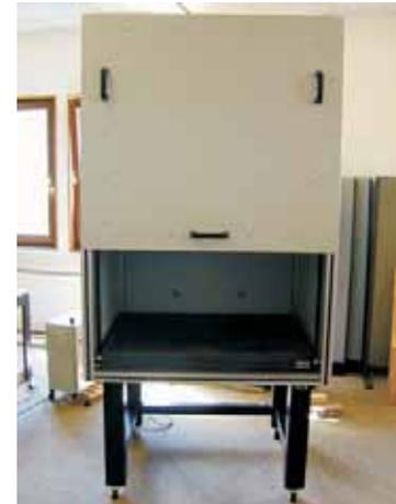
Abb. 3: Lichtdichter Faradaykäfig mit integrierter Schwingungsdämpfung
