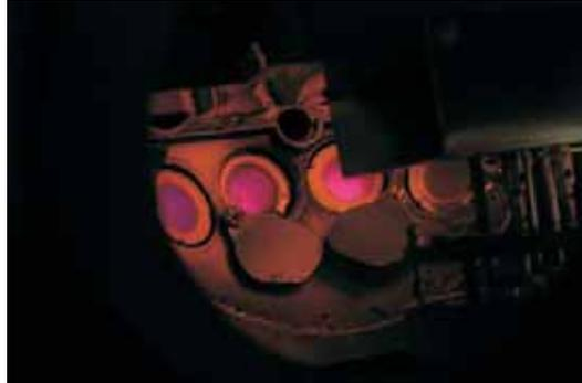
Abb. 2: Blick auf die Verdampferzellen in der Wachstumskammer.
