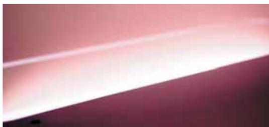
Abb. 1: Plasma in einer Sputteranlage für Präzisionsbeschichtung. Die Quelle misst 30 x 9 cm<sup>2</sup>.
