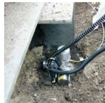
Abb. 5: Schwingungsmessung: Ist der Baugrund für die "Nano-Fab" geeignet?
