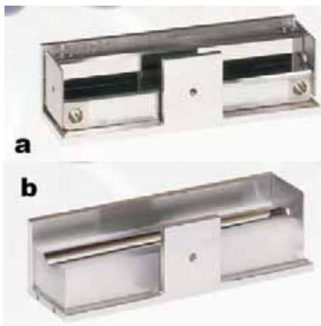
Abb. 3: Fokussierende Röntgenoptiken für Einkristalldiffraktometrie: (a) Montel, (b) SBM.
