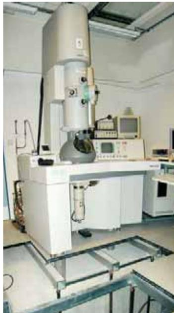
Abb. 1: Transmissionselektronenmikroskop auf pneumatischen Isolatoren in Unterflurtechnik
